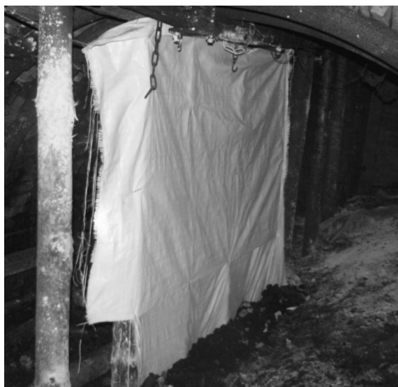
Rys.1. Widok tamy zamontowanej w kopalni węgla kamiennego [9]
