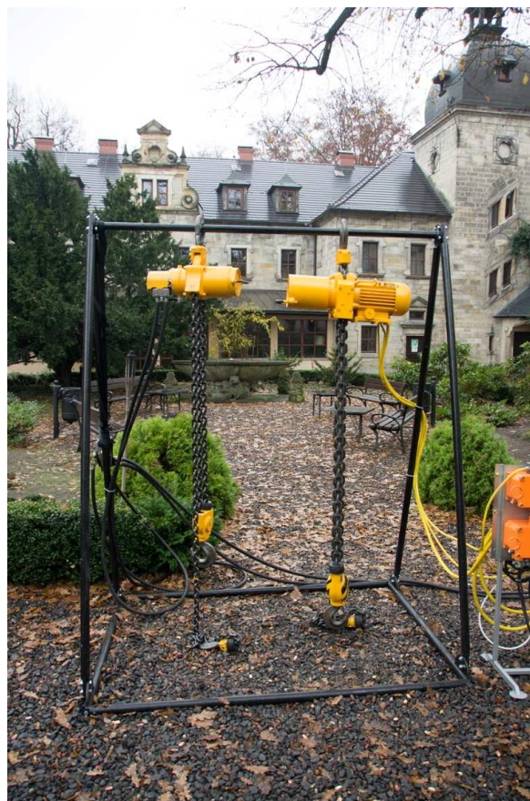
Rys.2. Prezentacja nowych rozwiązań wciągników (hydraulicznego i elektrycznego)
